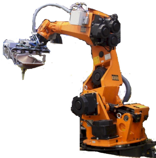
Figuur 1.2.11 Robot voor het plaatsen van een beeldbuis in een bewerkingsstation
